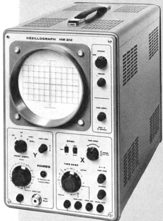
Der Oszillograf HM 212 ist eine Weiterentwicklung unserer bewährten Type HM 112. Verbessert wurden vor allem die Bandbreite des Meßverstärkers (jetzt 0-10 MHz -6 dB) und die Eichgenauigkeit der Zeitablenkung (jetzt  $\pm 5\%$ ). Ferner wurden durch den Einbau einer neuen Telefunken-Planschirmröhre Helligkeit und Strahlschärfe erhöht. Für die Industrie, Fachschulen sowie den RfK-FS-Service ist dieser Oszillograf gleichermaßen geeignet. Er ist das Produkt langjähriger Erfahrung auf diesem Gebiet.
